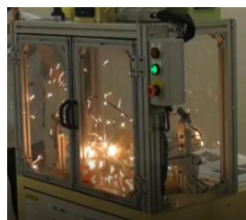
⑤トラッキング・過電流（電気による火災実演）
