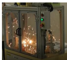
⑦トラッキング・過電流（電気による火災実演）
